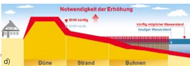
1.10 > Anpassungsstrategien a) „Linie seawärts vorverlegen“, b) „Linie halten“, c) „beschränktes Eingreifen“, d) „Linie landwärts zurückverlegen“ am Beispiel des Sturmflutschutzes mit einer Vollschutzdüne an sandigen Küsten
